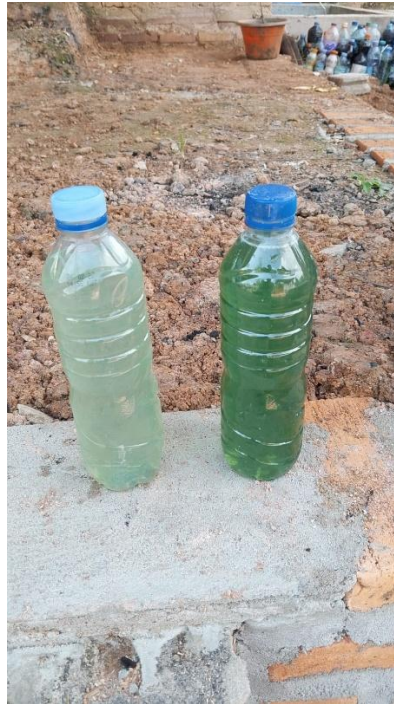
Gambar 3. Hasil limbah setelah dan sebelum filtrasi
