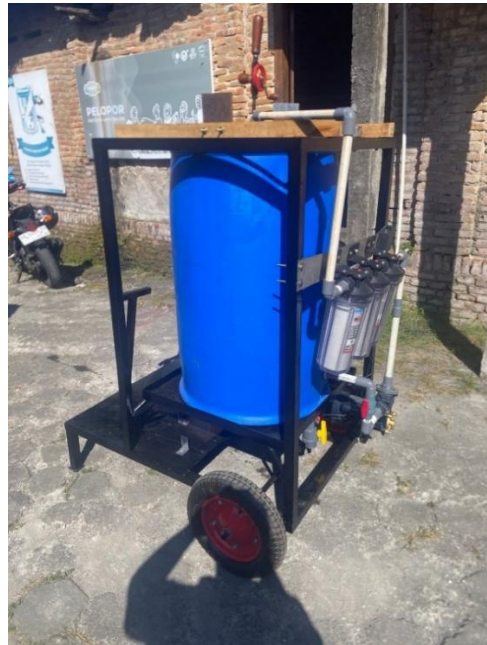
Gambar 2. IPAL Mini Mobile Berbasis Biofiltrasi
