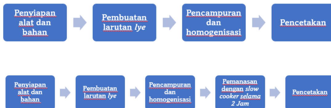
Gambar 4. Diagram Alir Teknologi Pembuatan Sabun Natural Kopi
