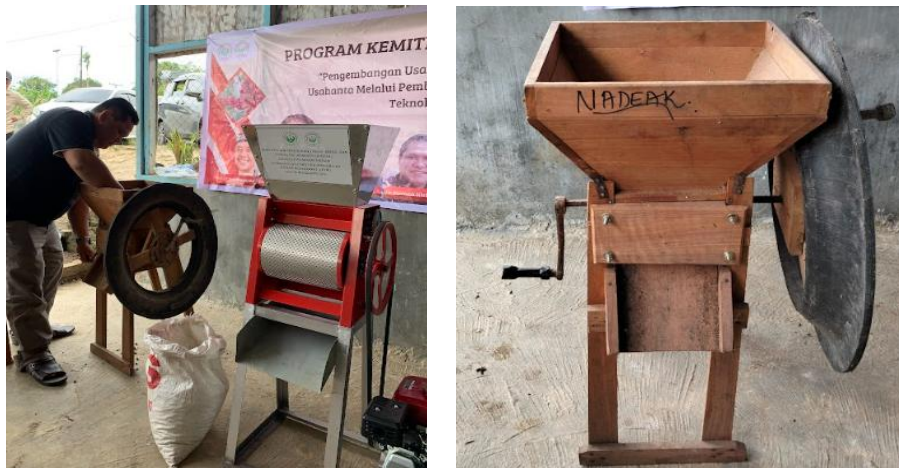
Gambar 13. Perbandingan Alat Tradisional Dengan Mesin Pengupas Kulit Kopi
