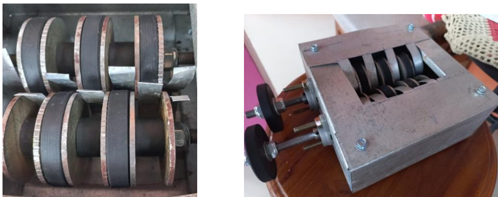
(a) (b) Gambar 6. Hasil Purwarupa Alat Pencacah Kertas
