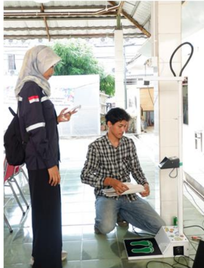
Gambar 2. Alat Ukur Berat Badan dan Tinggi Badan berbasis Aplikasi Android
