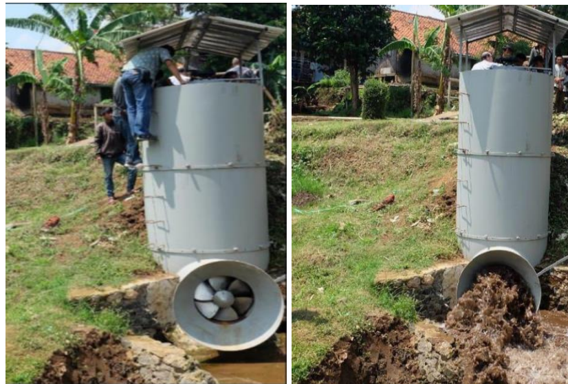
Gambar 3. Sudu turbin di Instalasi PLTMH (kiri). Aliran air keluar turbin (kanan)
